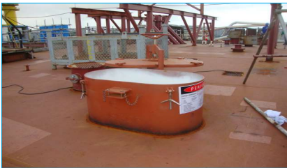
Boca de Visita de um Tanque de Carga de um Navio Petroleiro
